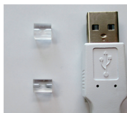
直線型測定セル (石英製、サファイア製)
