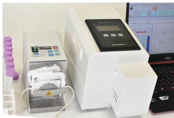
ポンプ・MH-6000A・パソコン等の設置例
